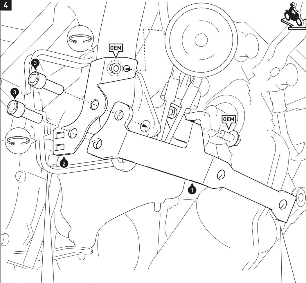
Verschrauben Sie auf der rechten Fahrzeugseite den Anbaubügel (1) mit dem Hupenanbaublech (2) am Fahrzeugrahmen.
