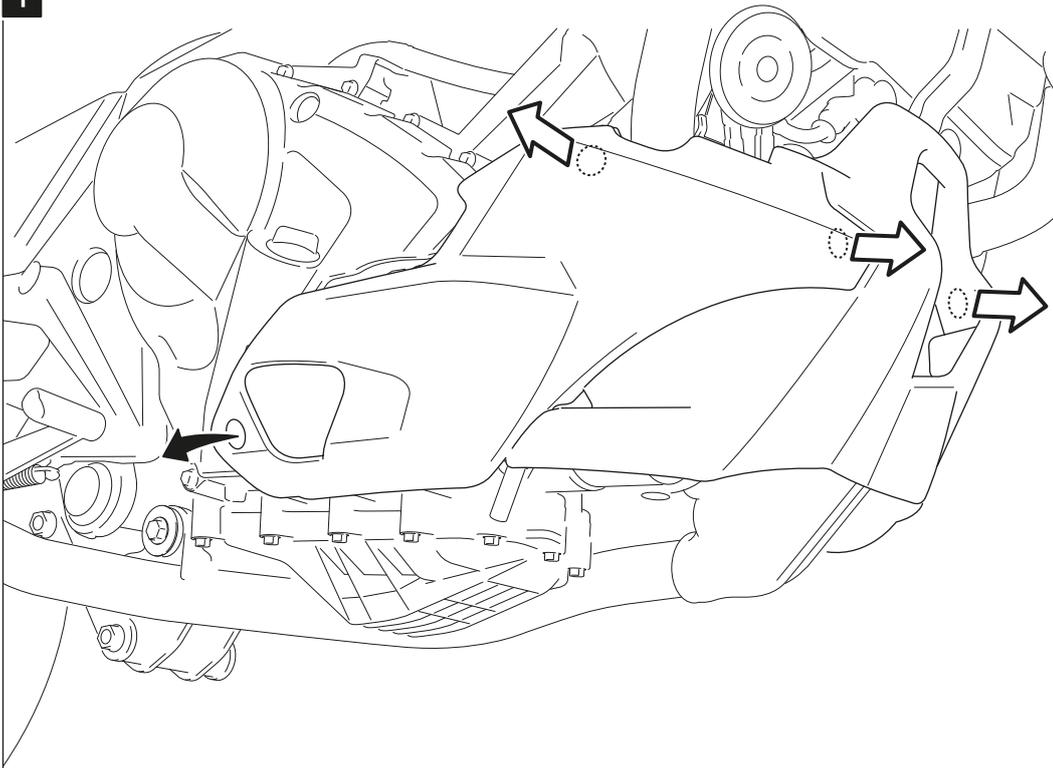
Lösen Sie auf der rechten und linken Fahrzeugseite die Schrauben der Motorverkleidung. Ziehen Sie anschließend die Motorverkleidung vorsichtig aus den seitlichen und vorderen Gummihalfterungen.
