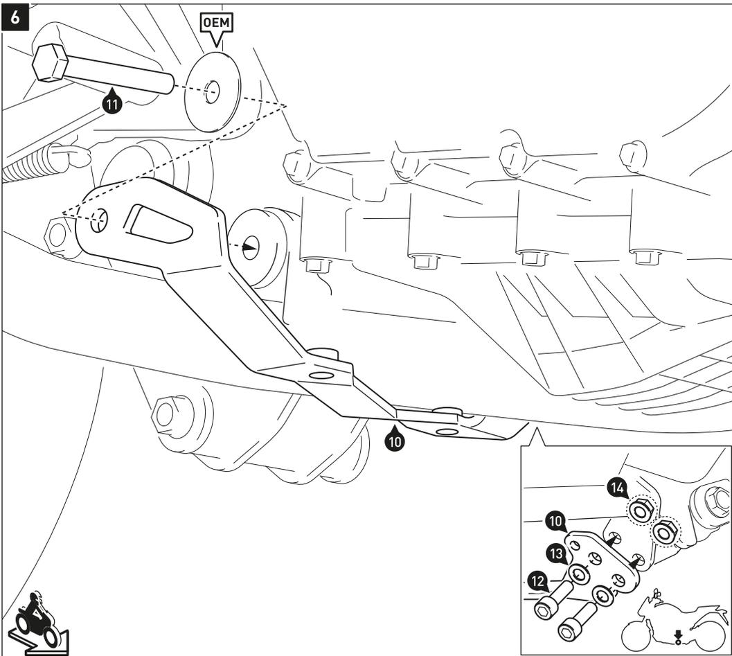
Verschrauben Sie den Anbaubügel (10) mit der originalen Unterlegscheibe (OEM) am Fahrzeug, wie in der Zeichnung und Detailzeichnung gezeigt.
