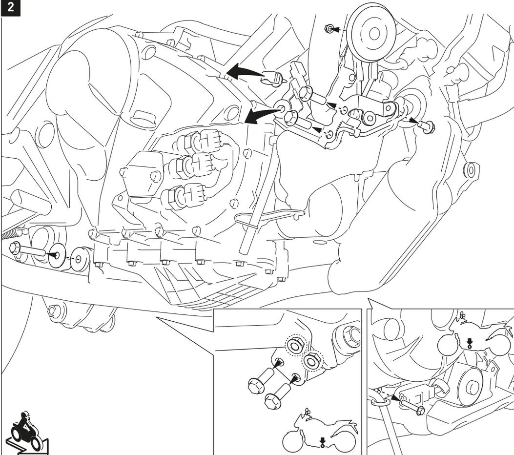
Entfernen Sie auf der rechten Fahrzeugseite die gezeigten Schrauben, Mutter und das Halteblech. Lösen Sie die Stecker von dem Halteblech.
