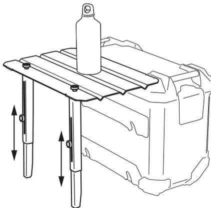
Haken Sie die Tischplatte in die Verzurr-Ösen des Deckels. Justieren Sie die Länge der Teleskopbeine über die Rändelschrauben.
