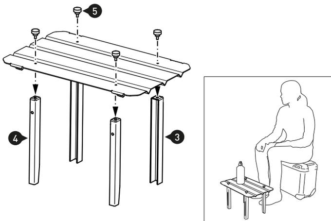
Demontieren Sie die Teleskopbeine und verschrauben die einzelnen Elemente mit der Tischplatte.
