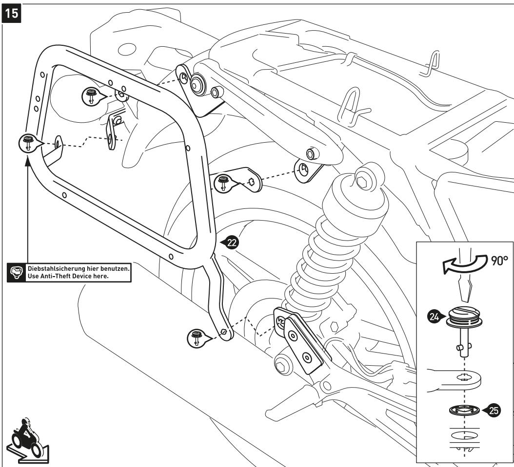
Verbinden Sie die Kofferträger (23) und (24) an den Befestigungslaschen und dem Querverbinder mit den Schnellverschlüssen (24). Sichern Sie die Schnellverschlüsse (24) mit den Sicherungsscheiben (25).
