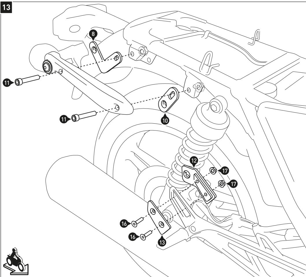
Verschrauben Sie die Seitenstreben mit den Schrauben (11), den Befestigungslaschen (8), (9) und (10) sowie den originalen Muttern am Fahrzeug.
